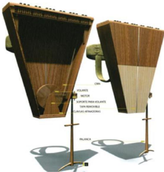
Figura 3. En esta representación tridimensional del interior de la viola organista se pueden ver claramente los elementos que componen el mecanismo del instrumento.
